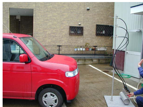
図 8 フロントガラスへの降雨試験
