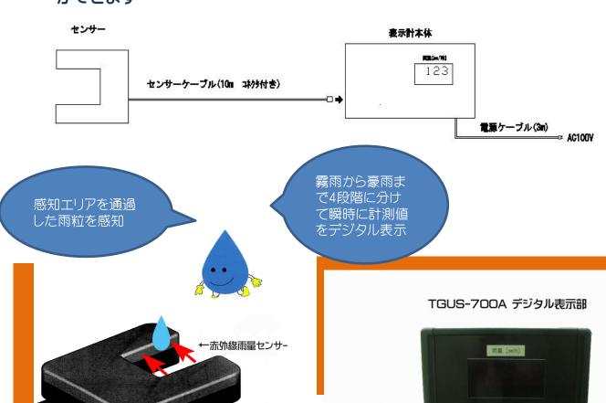
センサーと表示部で 構成されているので、 プラグインするだけで 雨量測定が可能です
