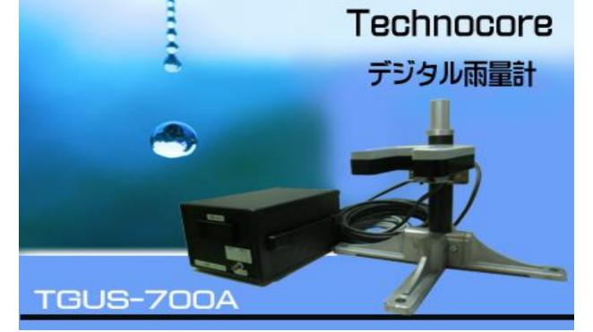
デジタル雨量計TGUS-700Aは、赤外線センサーが検知した瞬時の降雨状態を、時間あたりの降雨量 (瞬間最大降雨量) に換算して、デジタル表示します。 したがって、リアルタイムで降雨強度を知ることができます
